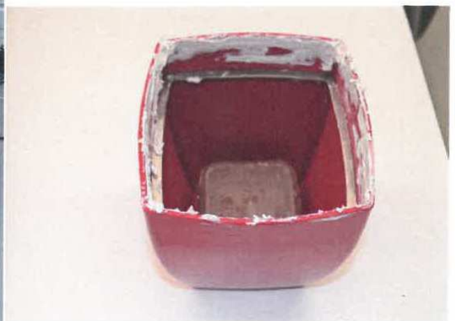
Рисунок 1 - Устройство для измерения концентрации газа радона, накопленного в течение 48 часов в герметичном контейнере (слева) и источник потока газа радона (справа).
