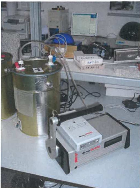
Рисунок 1 - Устройство для измерения концентрации газа радона, накопленного в течение 48 часов в герметичном контейнере (слева) и источник потока газа радона (справа).
